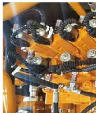
Пропускная способность главного клапана Kawasaki KMX36NA на 22% выше, чем у главного клапана 32NA, а координация значительно улучшена.
